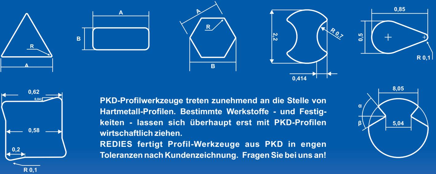
PKD-Profilwerkzeuge treten zunehmend an die Stelle von Hartmetall-Profilen. Bestimmte Werkstoffe - und Festigkeiten - lassen sich überhaupt erst mit PKD-Profilen wirtschaftlich ziehen.
